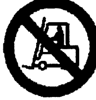
Prohibido a los vehículos de manutención
